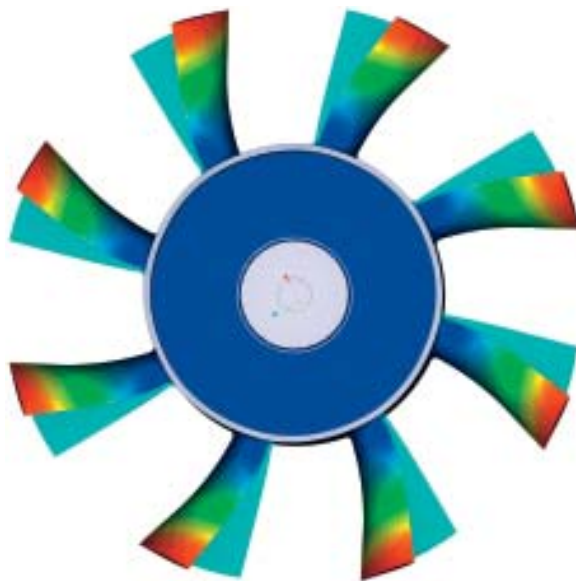
Das Fahrtwindgebläse; daneben die erste Biegeschwingung des Axiallaufrades, die über eine Modalanalyse ermittelt wurde
